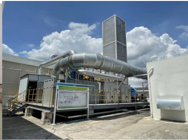
两级过滤系统+两级沸石转轮吸附+脱附浓缩+蓄热氧化燃烧装置
